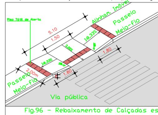
Fig.96 - Rebaixamento de Calçadas estreitas
